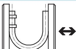
Прикрепленный к подвижной плите шланг изгибается до образования перегиба. Замеренное при этом значение и есть  $R_{min}$ . При искривлении шланга с радиусом  $R_{min}$  пропускаемый расход значительно снижается.
