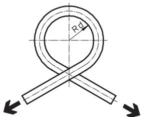
Шланг загибается до тех пор, пока его внешний диаметр в плоскостигибки не уменьшится на 5%. Для этого условия и определяется  $R_d$ . При радиусах гибки, больших, чем  $R_d$ , расход не снижается.
